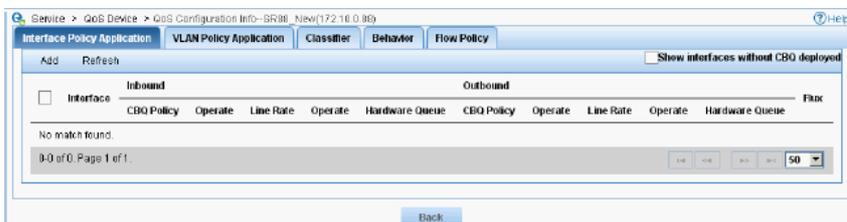
c.单击<增加>按钮，进入设备配置向导页。在接口应用策略中，点击选择的入方向的接口数的“设备接口选择”图标，选择入方向的接口，如下图所示：
