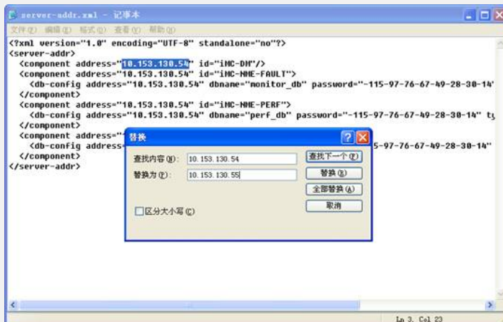
图3 对文件中的IP地址内容进行查找/替换操作
