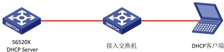
2.S6520X为DHCP服务器，客户端上连接入交换机通过DHCP获取地址，网关也在DHCP服务器上。
