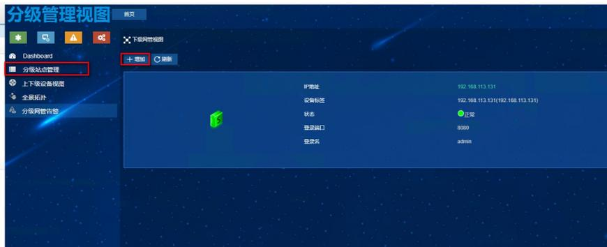
4、点击“选择设备”，选中第一步中纳管的下级iMC的IP地址，并填写下级iMC操作员的账号/密码，点击“确定”即可。
