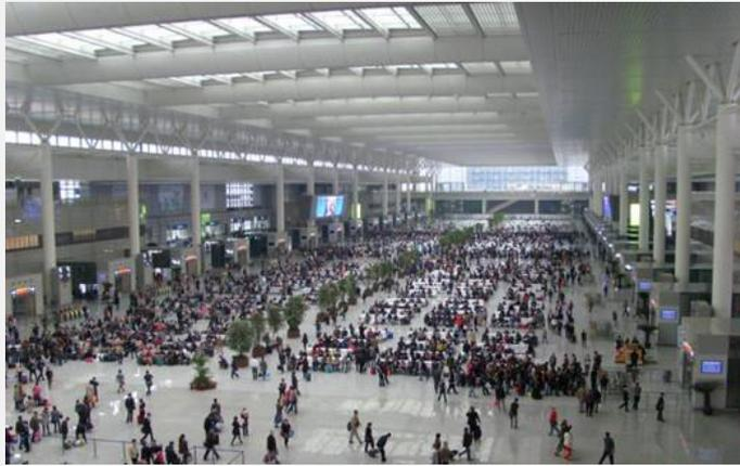
这种区域是典型的高密覆盖场景，总的覆盖原则为尽量降低AP的安装高度，寻找可以有效进行物理隔离的位置点安装，在条件允许的情况下，安装点可以选择靠近座位且高度很低的地方。
