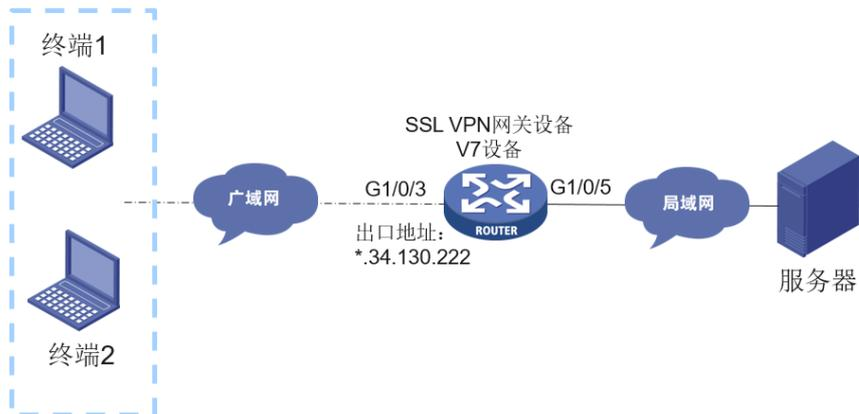
现场拓扑图如上，3口为外网口，同时作为SSL VPN的gateway地址接口。供移动接入人员的SSL VPN接入。
