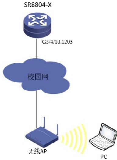
SR8804-X G5/4/10.1203接口作为ipv6网关给无线用户提供ipv6网络服务。无线终端通过无状态方式自动获取ipv6地址。用户接入方式采用的是ipv6 ipoe。
