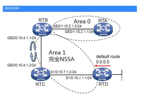
如上图,路由器RTA,RTB,RTC,RTD均采用ospf路由协议。现场RTA和RTB互联,互联链路在are a 0骨干区域中。RTB和RTC以及RTC和RTD互联链路划入到area 1中,并配置为完全NSSA(Totally NSSA) 区域。互联接口的网段如图所示。
