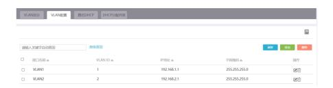
3、路由器lan1口连接交换机,将lan1口放通对应vlan 网络设置---LANP配置---VLAN划分
