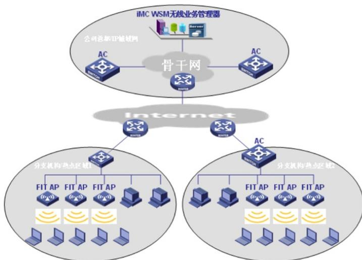
根据公司的要求, 需要为其多个分散的部署点提供较为经济的组网方式。为实现这一目的, 在网络部署上采用了无线控制器+Fit AP 的组网方式。在这种方式下, 无线控制器设备可以集中部署在企业骨干网络或运营商城域网中, 也可分布在企业分支机构等热点区域的入口, Fit AP 设备部署在企业各分支机构等热点区域无线控制器设备的下层, 与无线控制器设备配合提供无线接入, WSM 组件部署在企业骨干网络或运营商城域网中, 集中进行有线和无线网络的统一管理。
