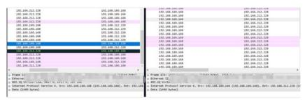
(2) 进一步确认设备上相关流量转发情况,发现对应流量在交换机上只进行二层转发。并且,该流量在S6520X上的上、下行口都进行了跨slot的聚合。
