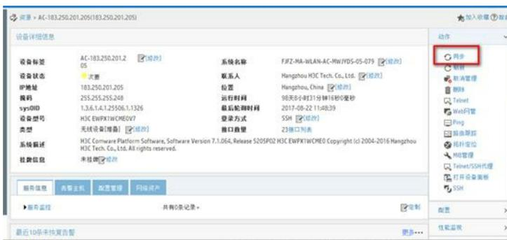
3、设备上设置snmp packet max-size 4096，然后“同步”设备，等待一段时间再观察；
