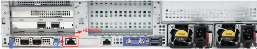
2. 网线连接完成，在PC端中配置相同网段地址。按Win键搜索【控制面板】—【网络和共享中心】—【更改适配器设置】—右键点击【以太网适配器】选择【属性】—【Internet 协议版本4 (TCP/IPv4)】—配置IP地址192.168.1.X，子网掩码255.255.255.0（注：IP地址中的“X”代表1或3-254中的任意数字，网关在PC端主机与服务器直连时不用配置。）
