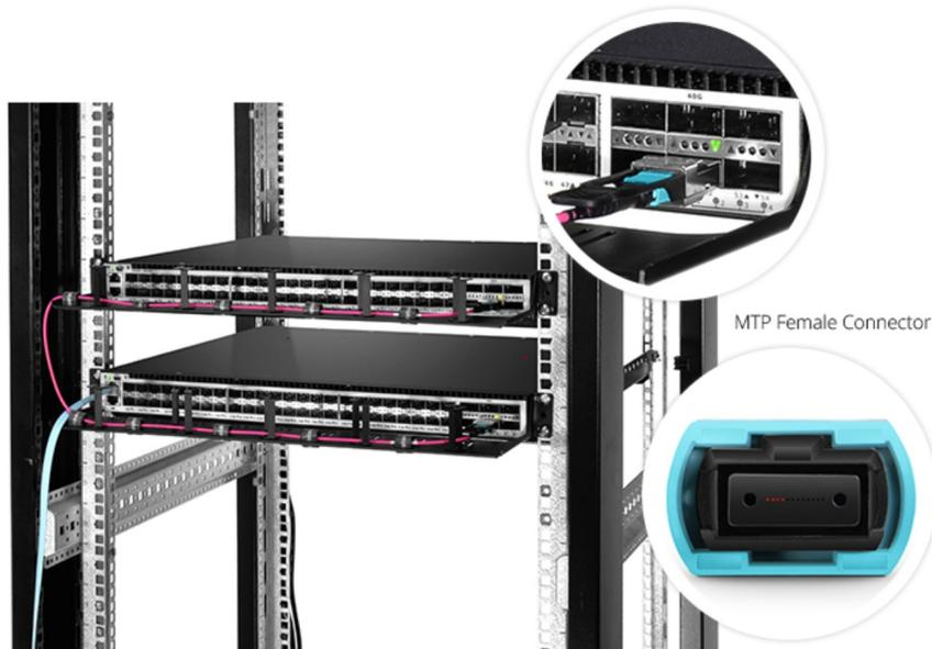
如果是右侧点亮则说明光纤的极性不对，机房布线一般推荐MPO/MTP光纤或跳线均为B型（交叉），完整的光信号传播路径示意图如下。
