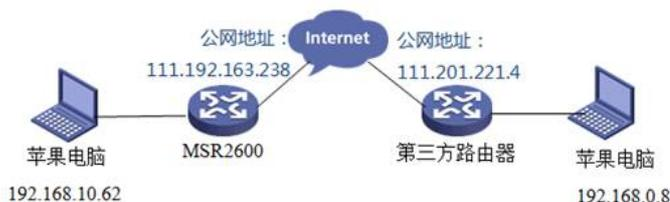
某局点反馈采用MSR2600路由器作为出口网关设备后，内网苹果电脑无法和外网的苹果电脑进行屏幕共享，但是更换其它厂商路由器正常，怀疑是我司路由器将Mac系统屏幕共享数据阻断了。
