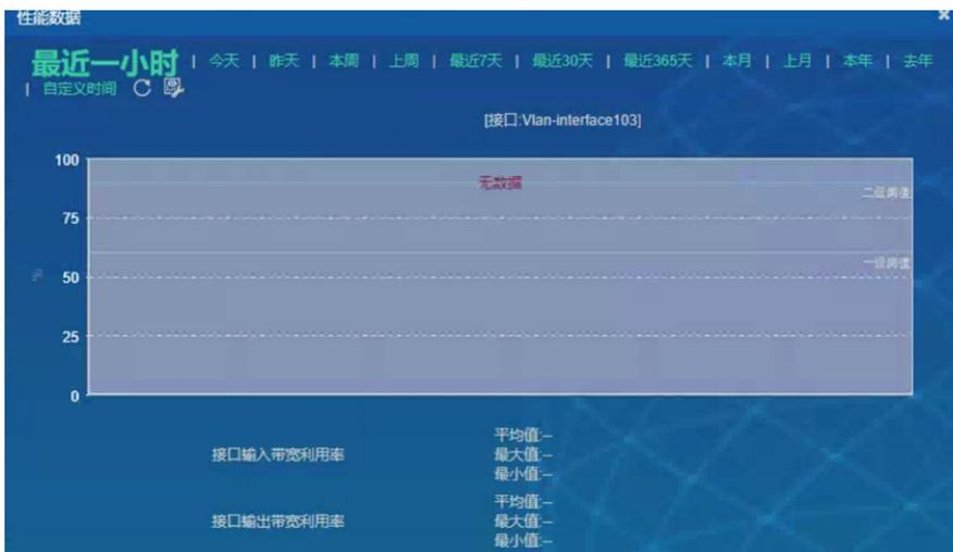
3、收集抓包和日志，进行分析，接口带宽利用率指标需获取接口速率作为计算利用率公式的除数，从抓包及mib管理读取设备mib节点发现现场该设备返回的接口速率为0，导致计算异常
