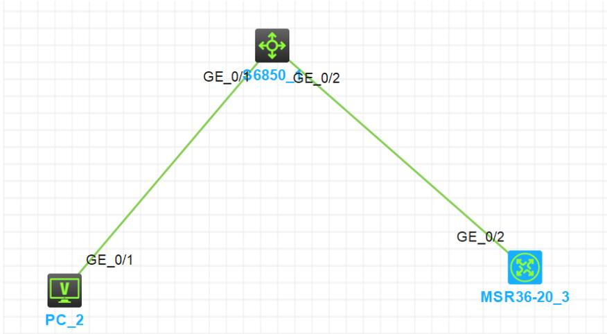
交换机充当不同网段的网关，直连终端，0/2口在vpn实例中，0/1口在public实例中实现pc2能ping 通msr3620
