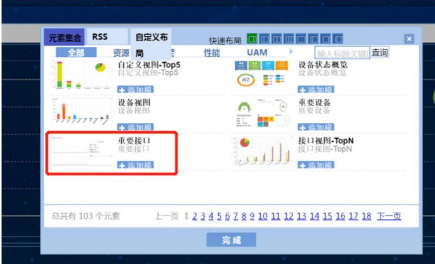
需要监控实例中对应接口的接口发送/接收速率，接口输入/输出带宽利用率（如下图圈红所示）
