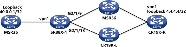
场景二，SR88X-1与右侧CR19K-R设备建立MPLS L3VPN，SR88X-1到CR19K-R有两条IGP公网路由，对应到两条公网LDP LSP。当SR88X-1收到本端CE MSR36发来的40.0.0.1访问4.4.4.4的流量，如果希望在两条LDP LSP负载，需要配置隧道策略，默认只走一条LDP LSP。
