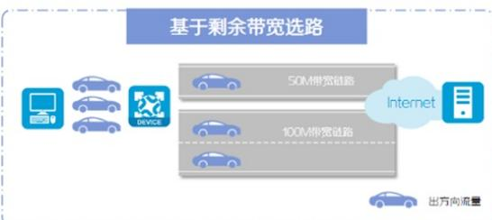
设备将按照剩余带宽的比例为链路分发流量，剩余带宽越大的链路会被分发越多的流量。
