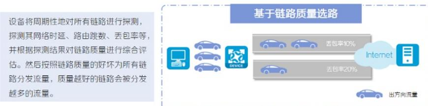
设备将周期性地对所有链路进行探测，探测其网络时延、路由跳数、丢包率等，并根据探测结果对链路质量进行综合评估。然后按照链路质量的好坏为所有链路分发流量，质量越好的链路会被分发越多的流量。
