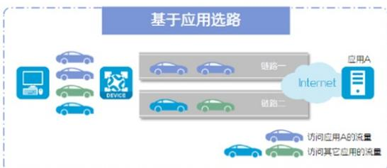
设备对业务流量的应用信息进行识别后，将访问相同应用的流量分发给同一条链路。例如，可以将访问关键业务的流量分发给质量更好的链路一，将访问其他非关键业务的流量分发给链路二，从而防止非关键业务流量抢占大量链路资源，保障关键业务流量的正常转发。
