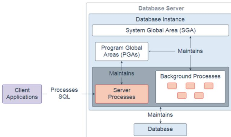
数据库实例包含一组Oracle数据库后台进程和内存结构。主存储器结构是系统全局区域 (SGA) 和程序全局区域 (PGA)。后台进程对数据库中存储的数据 (数据文件) 进行操作，并使用内存结构进行工作。数据库实例仅存在于内存中。
