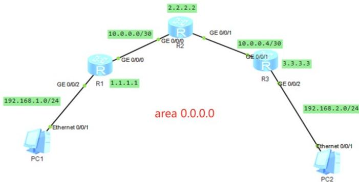
本案例采用ENSP模拟器来实现单区域OSPF的配置案例，IP地址规划在网络拓扑图中已经有了明确的标识，为了实现PC之间互通，使用单区域OSPF来实现。
