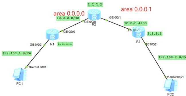
本案例采用ENSP模拟器来实现多区域OSPF的配置案例，IP地址规划在网络拓扑图中已经有了明确的标识，为了实现PC之间互通，使用多区域OSPF来实现。
