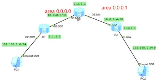
本案例采用ENSP模拟器来实现多区域OSPF的配置案例，IP地址规划在网络拓扑图中已经有了明确的标识，为了实现PC之间互通，使用多区域OSPF来实现，为了实现LSA的优化，本案例采用OSPF NS SA的方案来部署。
