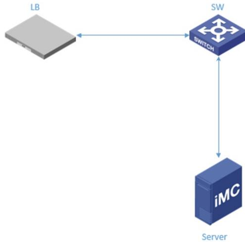
LB连接核心下联对应服务器
