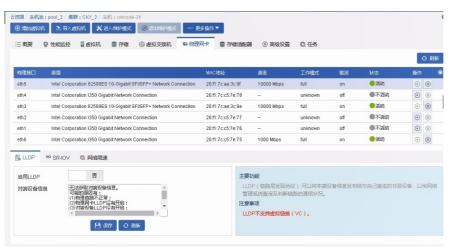
通过ping测试CVK主机之间通信正常。由于虚拟机上有业务,先将故障主机下的虚拟机迁移至其他正 常主机下。排查前后台的eth口信息,对应的mac址信息,发现CAS页面上所有正常主机的eth2口都是 万兆光纤, eth3口是干兆光纤, 只有故障主机的eth2口是干兆光纤, eth3口是万兆光纤, 即eth2和eth3 口反了。
