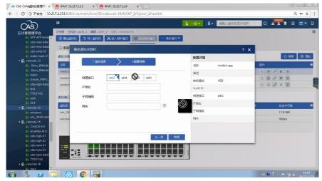
由于CVK13下没有虚拟机,点击虚拟交换机,找到eth2口对应所在行的修改按钮进行修改,在配置网 络部分将eth2改为eth3即可。
