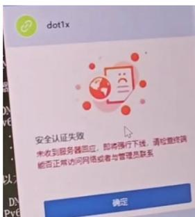
再排查网络, 用户端上线后的IP和iMC服务器IP不可达(组网特别原因), 因为iMC 网关在CoreSW上, 但用户IP GW不在, 路由不可达
