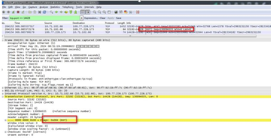
但此时Kafka并没有真正关闭连接，而是继续发送ACK报文（此时不会跳转会话状态，只有收到syn包才会跳转到稳态），后续正常报文的报文交互可以刷新TCP\_CLOSE老化时间并转发，但是报文23054和23118的间隔超过了2秒，导致会话被删除，造成后续Kafka服务器发给客户端的ACK报文重传被丢弃的现象。（安全策略只放通了客户端->服务器方向，反向策略未放通）
