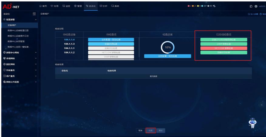
控制组件和所有设备建立一次SNMP连接，判断控制组件和设备之间的SNMP连接是否正常，用户名和密码的配置是否一致。若SNMP版本为SNMPv2c，仅使用读团体名检查控制组件和设备的连通性。如果SNMP通信异常，控制组件部分业务会受到影响，请联系技术支持工程师
