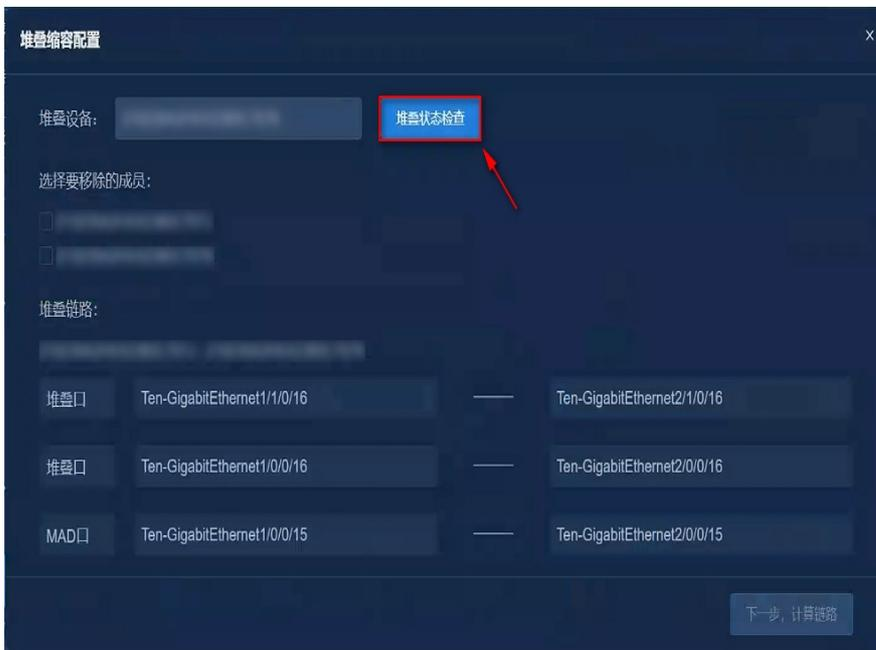
(4) 当【堆叠状态】页面显示堆叠链路均为“正常”时（如下图所示），【自动化拓扑】页面堆叠设备的“堆叠设备状态异常”状态即可消除。
