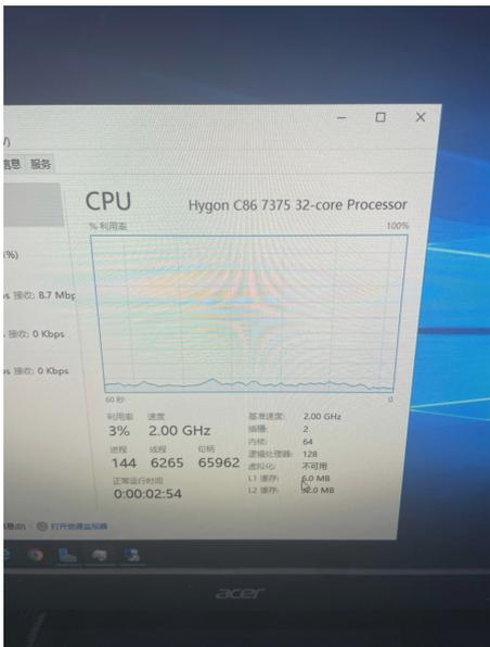
客户海光7375 windows 2019 设置CPU睿频，经查询此CPU最高睿频能达到3.0GHz，客户调整睿频选项后查看任务管理器CPU频率依旧为基础频率2.0GHz
