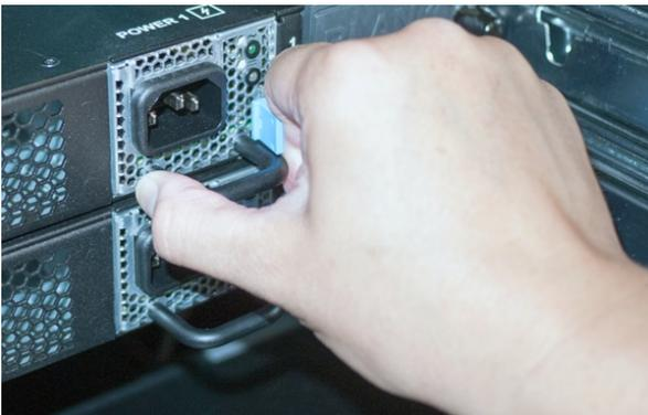
4. 如果您的新 PSU 上安装了输出连接器保护帽, 请在将其安装到系统之前将其移除。
