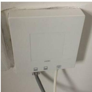
WA2610H-GN的正面面板上接口包含两个RJ45接口和一个RJ11接口（6孔4针电话线接口），如图
