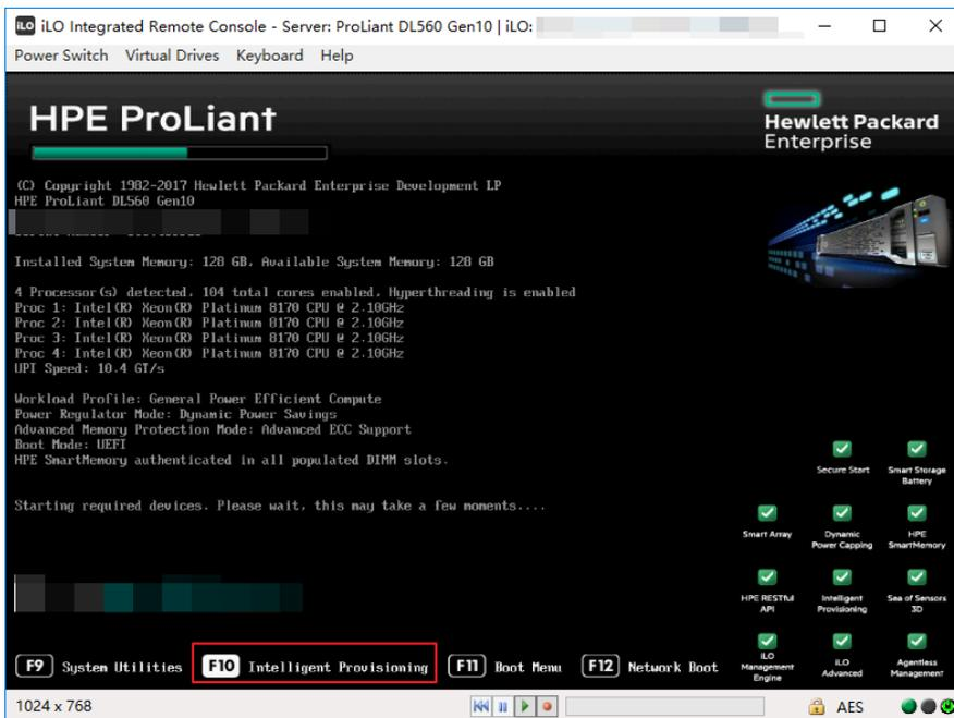
4. 进入IP后，我们需要先完成IP的初始化设置向导，选择“FIRST TIME SET UP WIZARD”。
