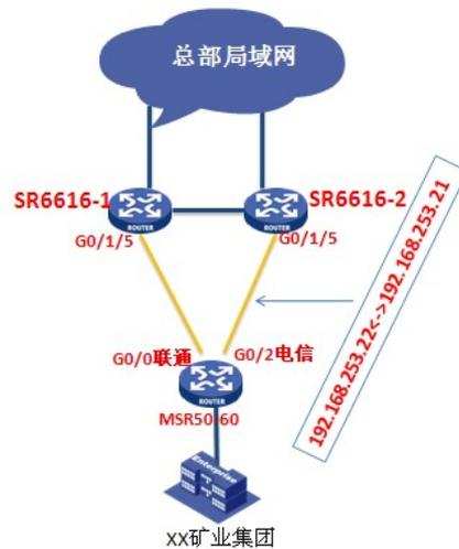
XX集团广域网通过2台SR6616路由器与各矿业集团MSR50-60组建，采用mpls vpn技术组网，SR66与MSR50-60都为PE设备。为了实现链路备份，总部SR6616与各矿业集团的MSR50-60路由器之间分别通过联通、电信的10M MSTP链路连接，广域网设备通过两条链路采用逐流的方式实现负载分担。
