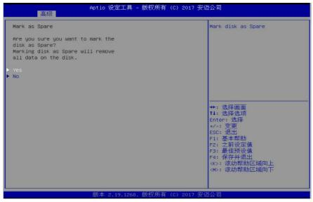
6. 操作完毕后界面会返回到All Intel VMD Controllers选项卡下,在该界面选择slot3槽位的物理硬盘Intel SSDPE2KX010T7按回车,可以查看热备盘是否添加成功。如下图所示:
