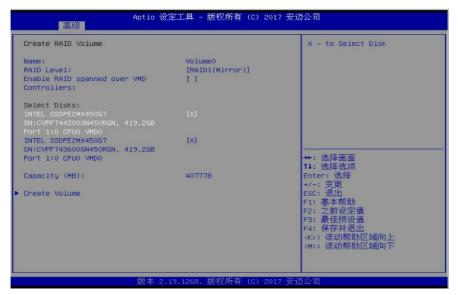
6. 选择**Capacity**选项按回车来填写要创建的逻辑卷的大小,在界面的右上角位置会显示可以填写的逻辑卷最大值,不能超过最大值否则会报错。如下图所示:
