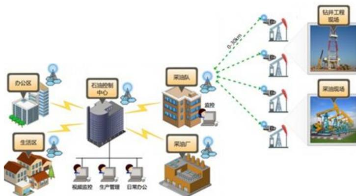
分支功能区和中心区域的互联，采用桥接设备实现，在应用上没有什么特别的，但强烈建议采用一对一的桥接，不建议采用一对多模式。采油点的监控选择无线监控方式，可以极大地降低部署成本。很多监控摄像头都配置了WIFI芯片，可以接入AP，采集的图像也能够无线回传到汇聚点。现场根据监控所需流量，以及抽油机数据所需带宽，可以考虑将数据采集和监控流量合并起来通过一个无线链路回传，整体上降低部署成本。
