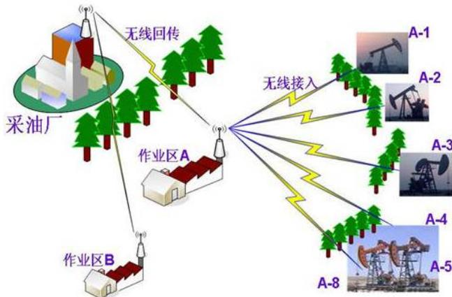
使用无线桥接设备搭建无线链路，是这种情况下最好的一种可选方式。在决定采用桥接方案进行收发端数据链路构建后，需要组织人力进行现场的勘察。勘察内容涉及桥接设备和天线安装的位置、桥接点之间的距离、采用何种天线、供电方式确定、相关的附件配置，以及综合用户的需求进行及时调整。在产品配置方面应该采用无线桥接设备，匹配适宜增益的天线，以及相关配套的专业附件。
