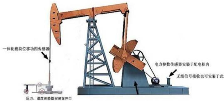
要实现数据回传需要将收发两端进行链路连接，这样分散的采油点数据信息就可以进行回传，然后汇聚到一个中心点后便可以进行集中监控和呈现。
