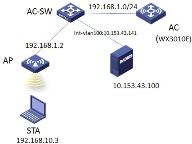
本配置举例中，使用WX3010E作为无线控制器，版本号为R3507P14。AC作为AP网关（via n-interface10:192.168.1.1/24）并配置DHCP server为AP分配IP地址。AC作为STA网关(vlan-interface10: 192.168.10.1/24)并配置DHCP Server为STA分配IP地址。交换机为AP提供POE供电。
