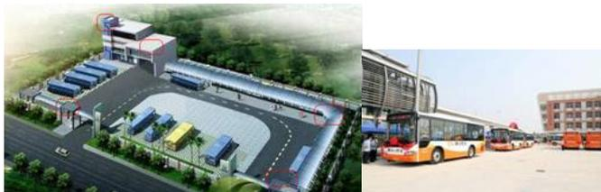
可选择总站所处环境中位置较高处(上图中圈红色部分)进行AP和天线安装,可墙壁安装或者制作杆子进行抱杆安装。天线一般采用定向天线,且需要调整天线以使主波瓣对准公交车停放区域。
