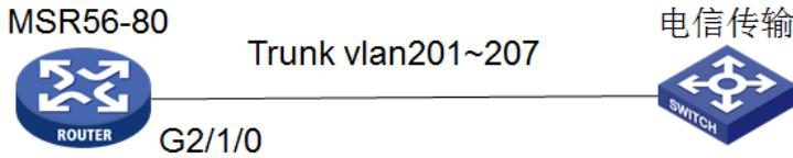
查看该板卡与设备间适配，槽位也符合规格表要求。由于中间传输是运营商的二层网络，替换后ping不通区县ip，在设备上查看arp表项并没有学到区县的arp。在设备上打印debug arp packet，可以看到设备已发送arp请求报文，没有得到回应，从现象看应该是对端没有收到arp报文或者回包没有被设备接收和识别。
