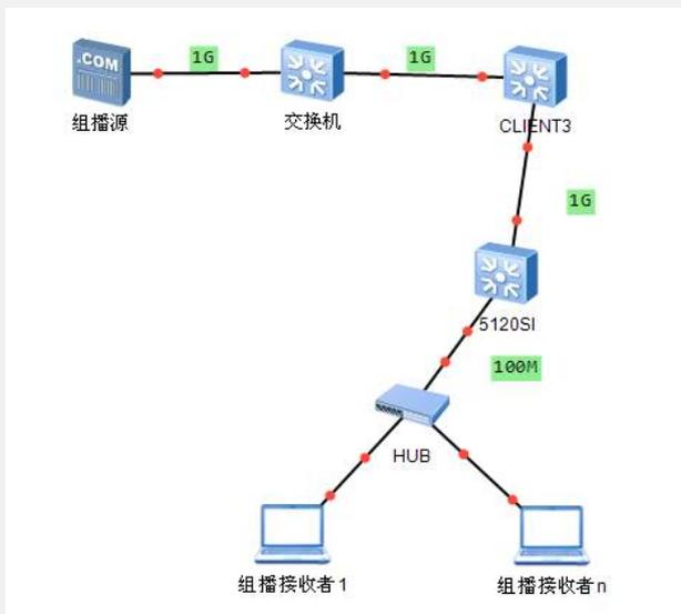
用户网络运行组播业务，server上承载着n多路组播数据。5120SI设备上上行1G下行100G，存在高速打低速的情况。开启burst-mode enable后有好转但是仍存在故障。
