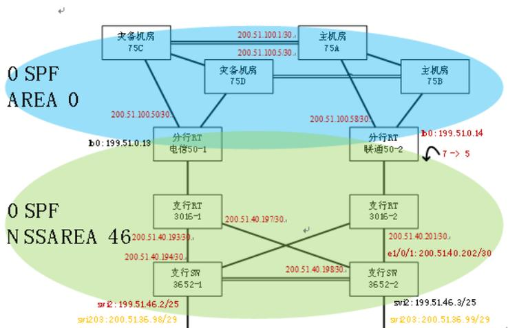
某局点通过我司4台S75E组建核心网络，其中4台S75E根据定位不同分为两组：中心机房和灾备机房，同一机房两台S75E通过聚合链路互联，不同机房S75E间通过2条三层线路互联，建立两个OSPF邻居，运行在OSPF Area 0中。各个支行通过两台MSR3016上行到分行，分别通过电信和联通线路接入核心网络，运行在Area 46中。近期客户进行网络优化，为减少网络中路由数目，客户把支行网络的OSPF Area设置为NSSA区域，发现原本负载均衡的网络流量都通过联通下行，路由学习出现问题。MSR3016-2上原本应该能学到两条去往业务网段的等价路由，现只有一条路由进入路由表；灾备中心S75E (S75C、S75D) 上原本应该只有一条去往业务网段地址，指向各自连接的下联MSR5040，先出现3条等价路由，指向中心机房S75E (S75A、S75B)。
