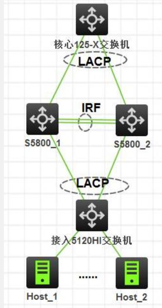
两台S5800设备作为汇聚设备且配置了IRF2.0功能，核心设备使用S125-X设备，接入使用的是S5120HI设备。汇聚与核心及接入间使用动态链路聚合互联。
