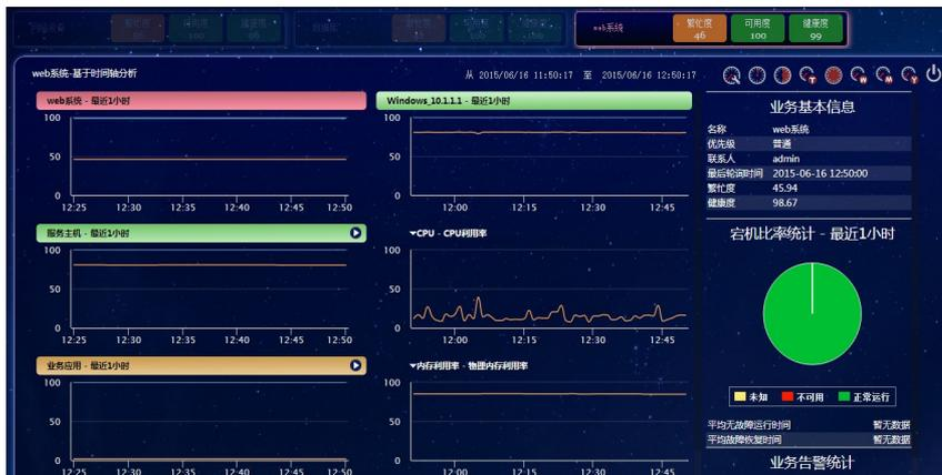
7. 业务的健康度、繁忙度、可用度由各个应用指标的监控结果通过加权计算所得，如果需要设置各个指标的权重，可以点击业务监控中的“权重分配”；业务的监控结果超过事先设置的“阈值”时MC会产生相应的告警通知管理员，如果要设置告警阈值，可以点击“阈值设置”。如下图：
