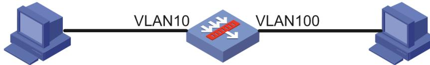
如上图, F5060两边是两台终端, 分别属于VLAN10和100, 配置跨VLAN模式Bridge使VLAN10和100互通
