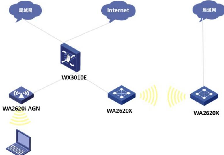
主楼无线网络使用AC+FIT AP方式部署，AC型号为WX3010E，主楼信号覆盖AP为WA2620i-AGN，桥接AP型号为WA2620X并配置外置天线，主副楼之间通过桥接技术建立链路，副楼局域网数据通过桥接传送到主楼。
