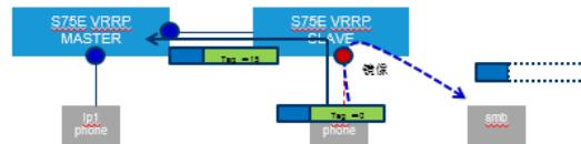
问题要么是S75E 备机所有芯片都修改ip phone原始报文导致，要么就是ip phone发出报文有问题导致，基于我们对芯片的了解，出现这个修改tag的问题只有现场配置voice vlan和gust vlan两个配置，检测芯片的表项，并未看到有修改的配置残留或者修改。
