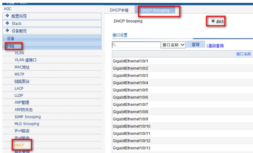
2) 把接DHCP 服务器的接口 (GigabitEthernet1/0/1) 设置为信任端口其他端口设置为非信任端口
