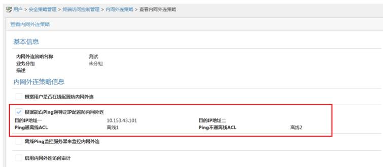
基于ping的离线ACL主要是用于离线情况下针对不同场景进行ACL控制，仅针对离线场景。在不下发在线非认证网卡ACL时，网卡使用定制时默认的ACL。若默认为禁用，则网卡无法ping通网络。
