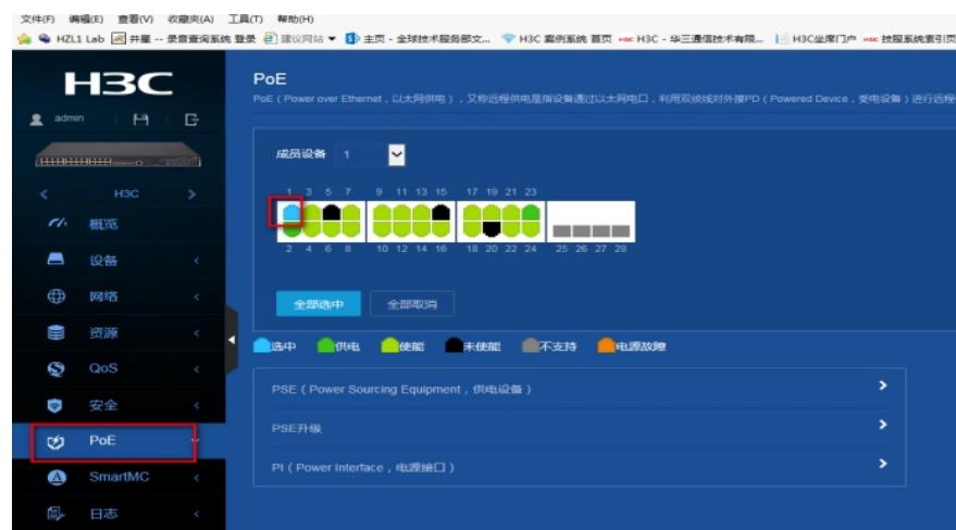
(3)点开“PI (Power Interface, 电源接口)”选项, 远程供电按钮选择开启
